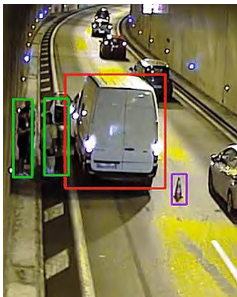
La technologie Cyclope.ai permet de détecter les incidents dans les tunnels.
